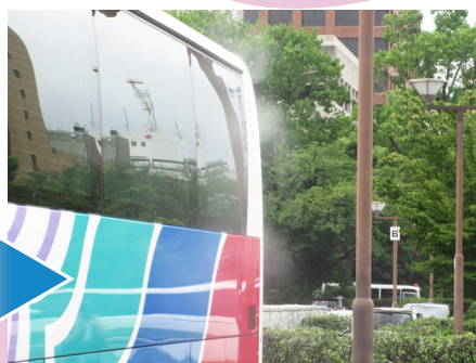
バス車外 煙排出状況
